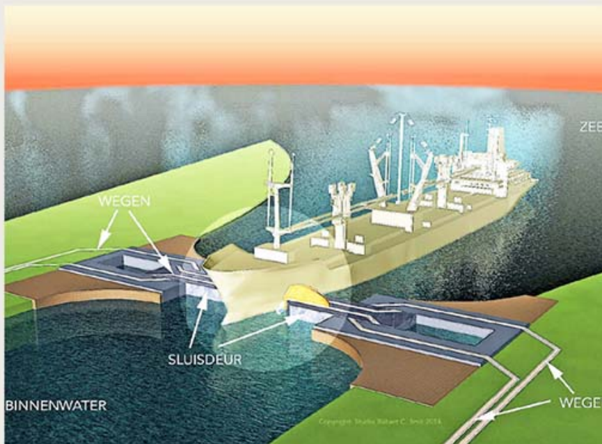
De werking van de alternatieve sluis.
