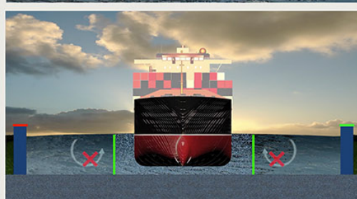
Ingenieur schutten: schepen varen tegen een flexibele deur die de vorm van de boeg volgt.
