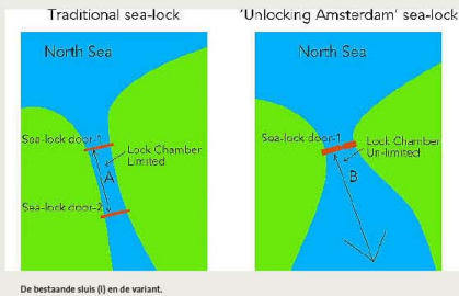
De bestaande sluis (l) en de variant.
